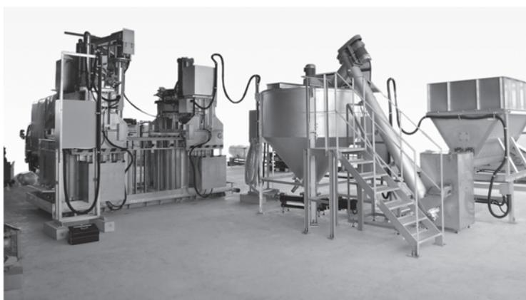
写真2 15馬力高速破碎機+1000L2槽式+周辺機器設置例
