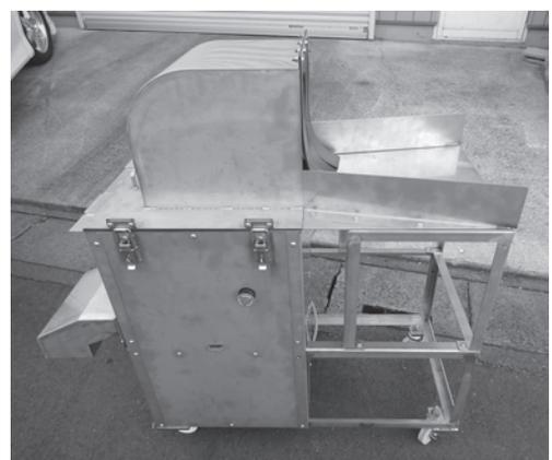
写真3 高速破碎機の単体例
